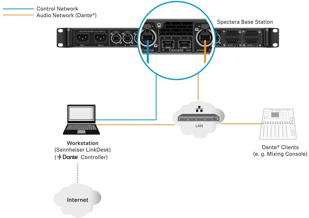
Dans cette configuration, un poste de travail est utilisé pour toutes les applications logicielles client (Sennheiser LinkDesk, Spectera WebUI, Dante® Controller). Soit deux interfaces de réseau filaire séparées sont utilisées pour la commande et l'audio (Dante®), soit une interface est partagée. Veuillez noter que, dans ce type de configurations (en général), aucun service DHCP n'est activé. Utilisez les paramètres IP manuels ou la configuration ZeroConf.
