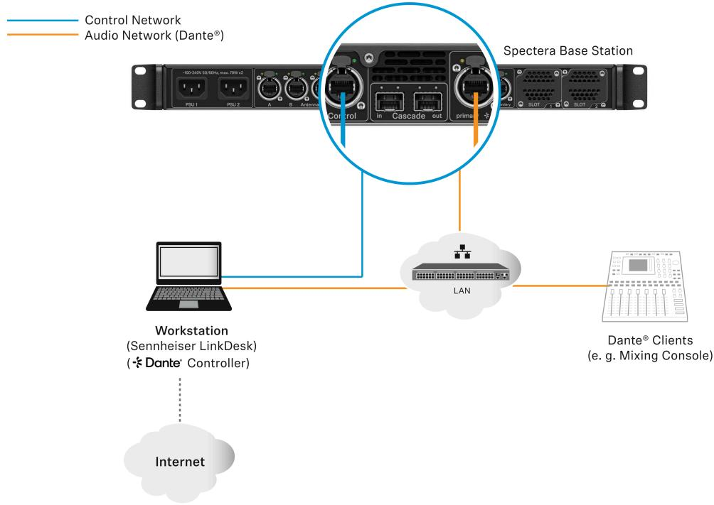
Nesta configuração é utilizada uma estação de trabalho para todas as aplicações de software do cliente (Sennheiser LinkDesk, Spectera WebUI, Dante® Controller). São usadas duas interfaces de rede com fio separadas para o controlo e áudio (Dante®) ou é partilhada uma interface. Tenha em atenção que, nestas configurações, (tipicamente) não é ativado um serviço DHCP. Use definições de IP manuais ou configuração ZeroConf.
