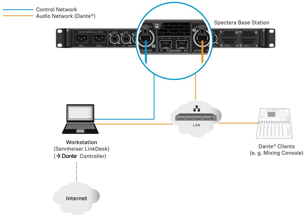
在此设置中，单个工作站将用于所有客户端软件应用程序（Sennheiser LinkDesk、Spectera WebUI及Dante®控制器）。可采用两个独立有线网络接口分别传输控制信号与音频(Dante®)，亦可共享单一接口。请注意此类设置（通常）不激活DHCP服务。请选择手动IP设置或ZeroConf配置。
